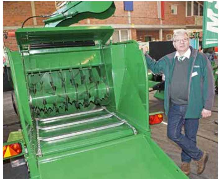
Lely stellte den Fütterungsroboter Vector MFR M2 vor, bei dem Behälter und Mischschnecke jetzt komplett aus Edelstahl bestehen, was den Verschleiß wesentlich reduziere. Bestimmte Bauteile seien jetzt so angeordnet, dass sie leichter ausgetauscht werden können (v.l. Yannik Salzmann und Torsten von Zweydorff). Einstreugeräte wurden von verschiedenen Herstellern vorgestellt, so auch von Mc Hale (im Bild Gerd Bleicker).
