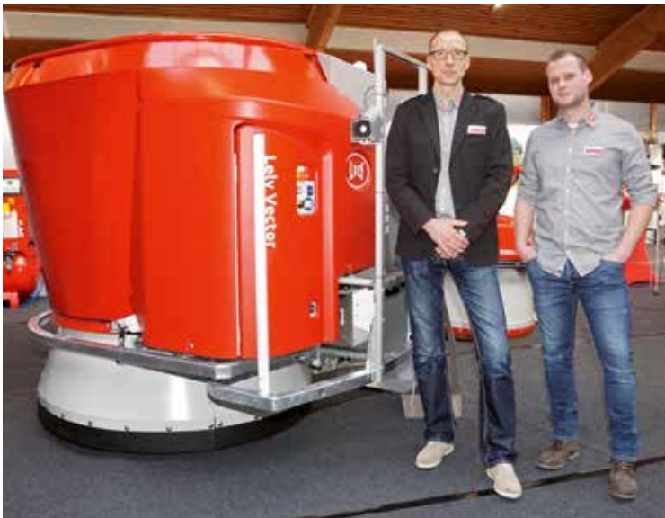
Lely stellte den Fütterungsroboter Vector MFR M2 vor, bei dem Behälter und Mischschnecke jetzt komplett aus Edelstahl bestehen, was den Verschleiß wesentlich reduziere. Bestimmte Bauteile seien jetzt so angeordnet, dass sie leichter ausgetauscht werden können (v.l. Yannik Salzmann und Torsten von Zweydorff). Einstreugeräte wurden von verschiedenen Herstellern vorgestellt, so auch von Mc Hale (im Bild Gerd Bleicker).
